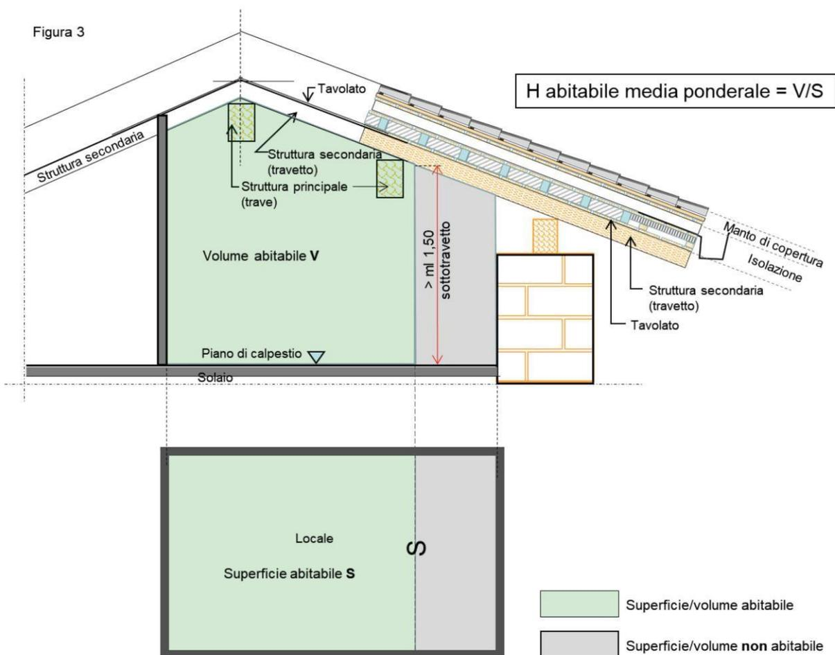
A titolo esemplificativo, la figura 4 illustra il volume abitabile che praticamente non include la struttura secondaria, comprendendo invece l'eventuale struttura principale (in quanto non rileva ai fini della misura dell'altezza).
